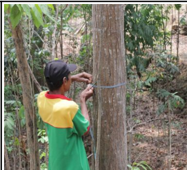
Gambar 2. Mengukur Diameter Pohon
